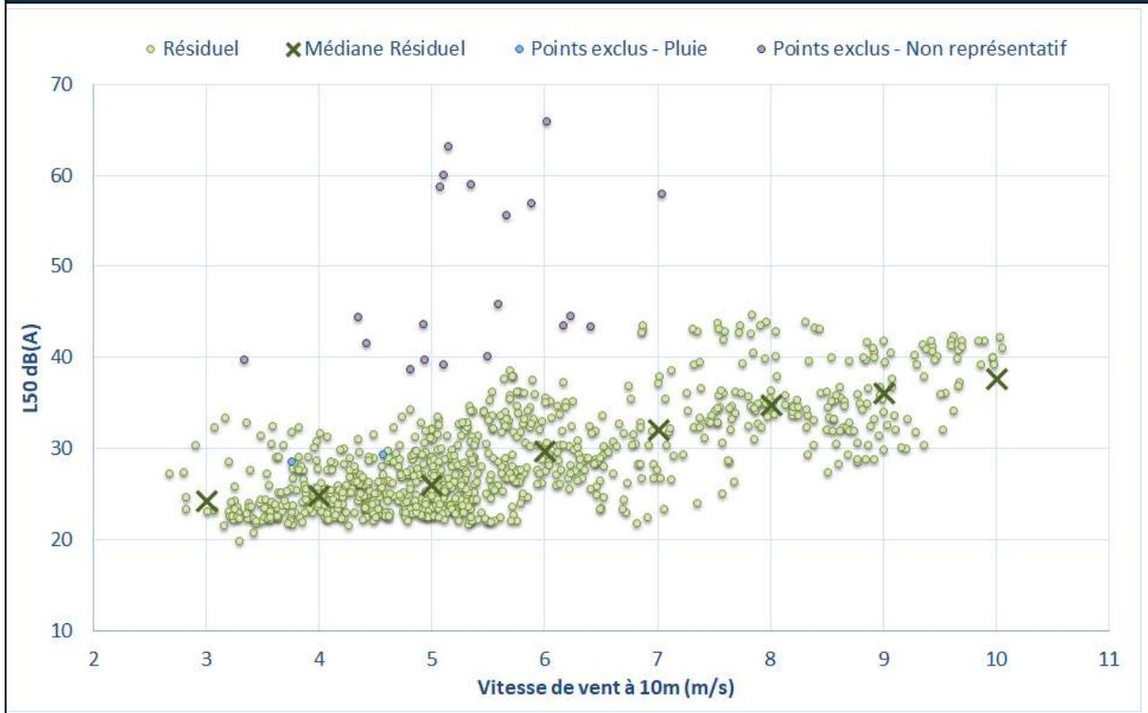
Figure 6 : Bruit en fonction de la vitesse de vent standardisée au point P2
