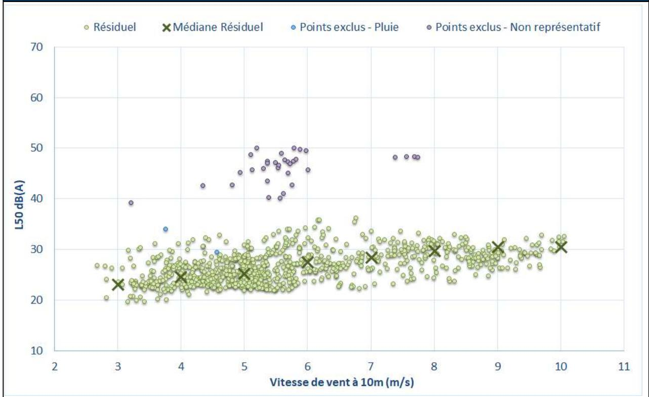
Figure 5 : Bruit en fonction de la vitesse de vent standardisée au point P1
