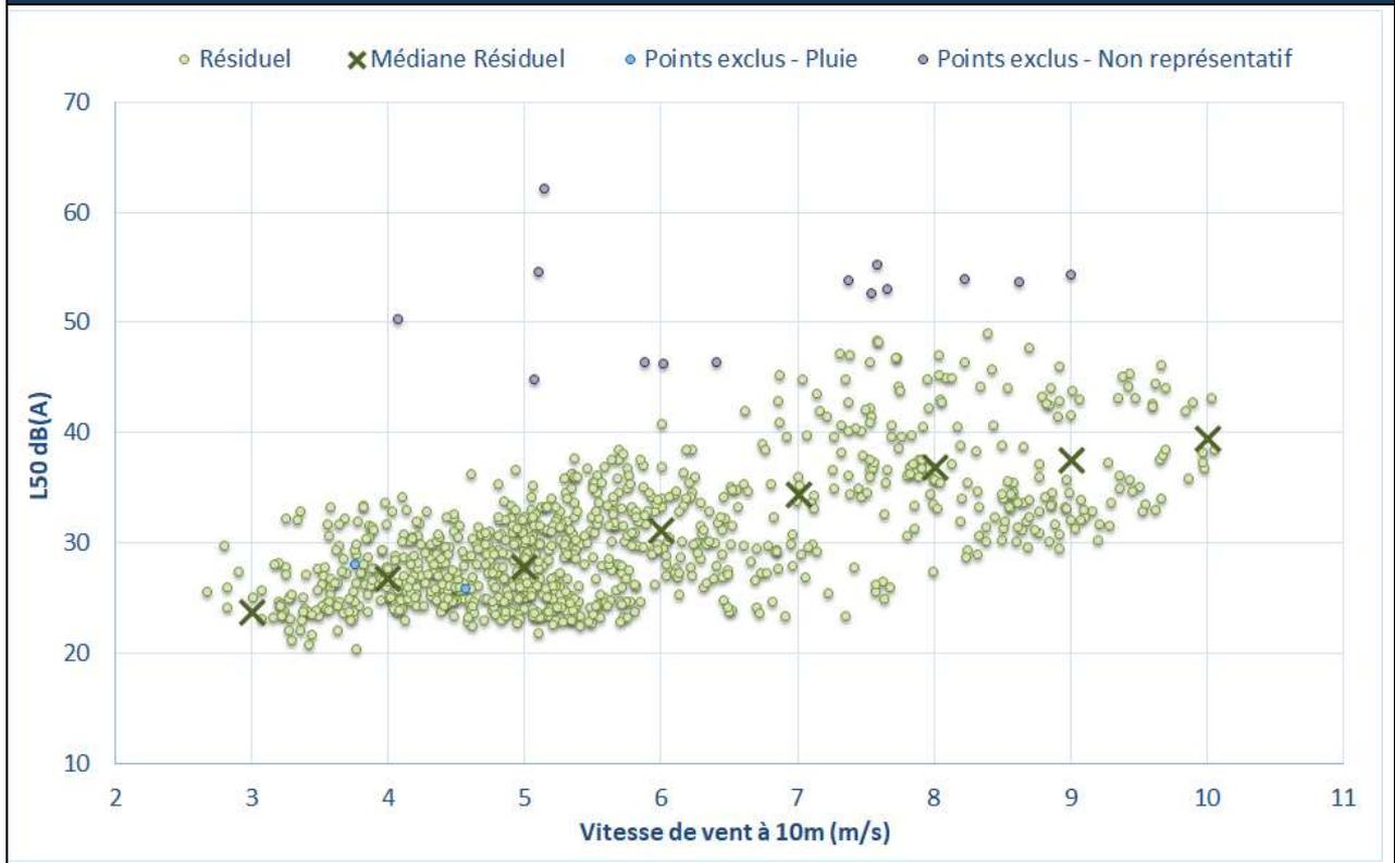
Figure 8 : Bruit en fonction de la vitesse de vent standardisée au point P4
