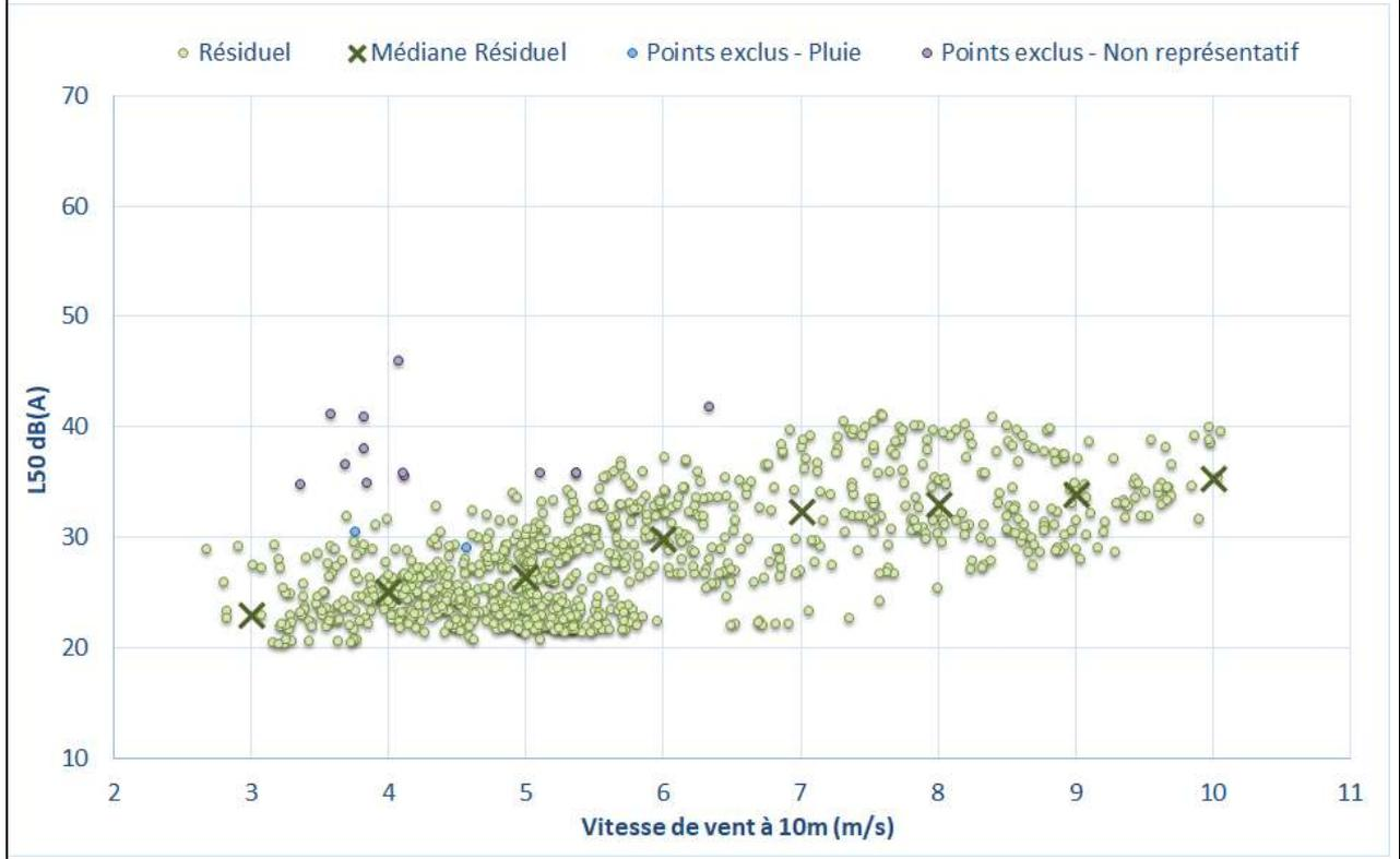
Figure 10 : Bruit en fonction de la vitesse de vent standardisée au point P6
