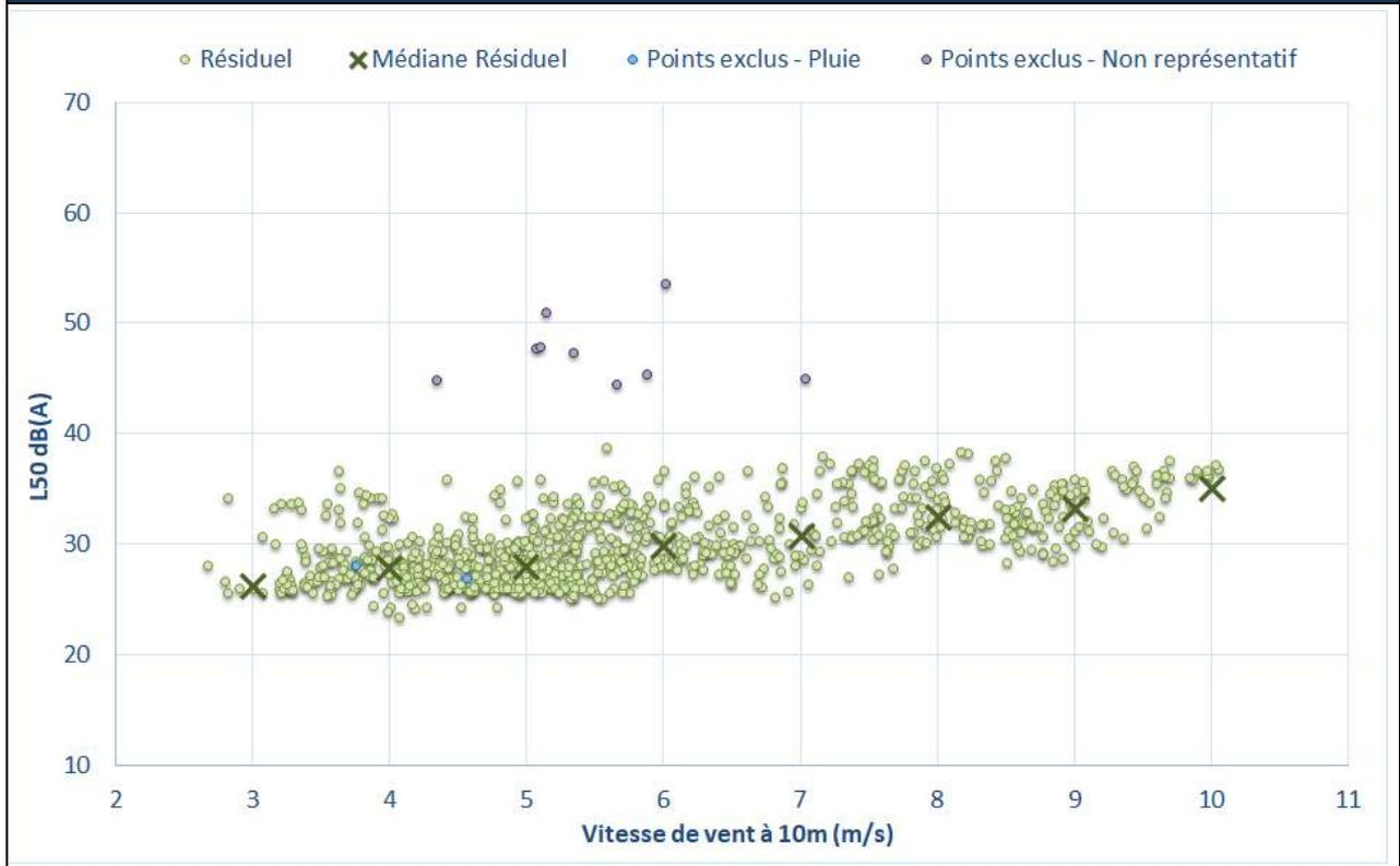
Figure 9 : Bruit en fonction de la vitesse de vent standardisée au point P5
