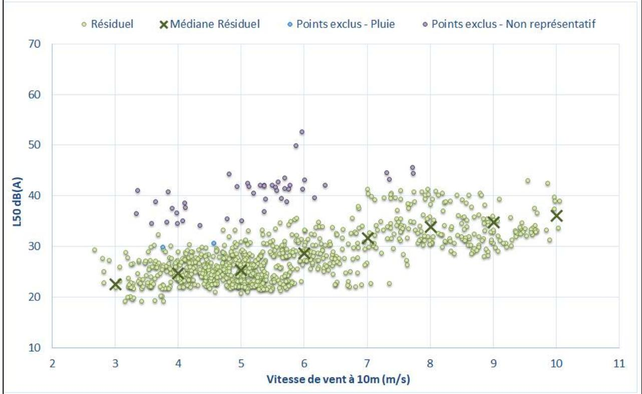
Figure 11 : Bruit en fonction de la vitesse de vent standardisée au point P7
